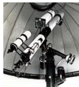
屋上天文台内に設置されていた大型屈折赤道儀式天体望遠鏡の初代機（対物レンズは直径15cmのアカロマート）。
