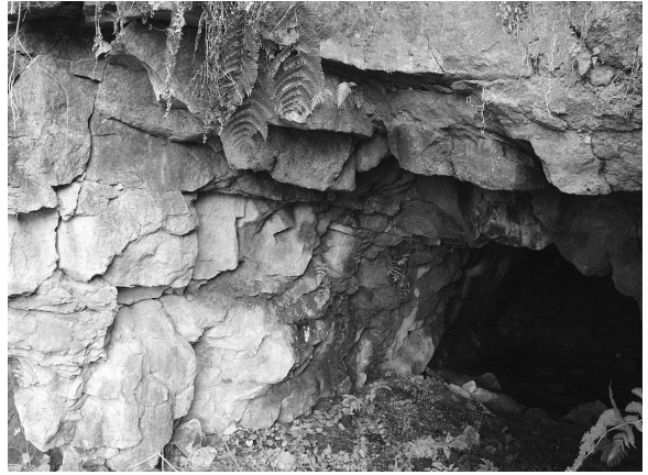
写真10 市営立矢団地裏側の笏谷石採掘坑道入口
