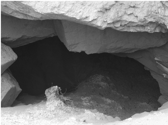
写真59 陥没穴底の破断口と空洞(坑道)の拡大
