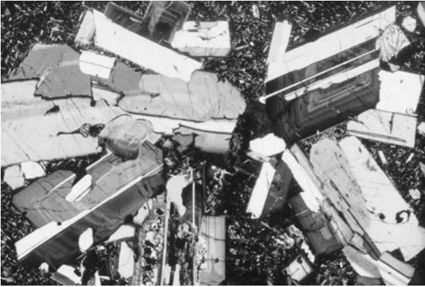
写真1 : 01千畳敷(10倍, 直交ポーラー)斜長石の集合結晶
