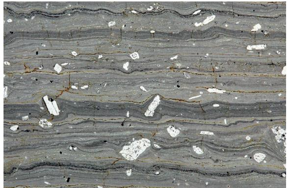
写真11. 雄島流紋岩の大型岩石薄片を透過光で撮影. 写真の横幅は約20mm
