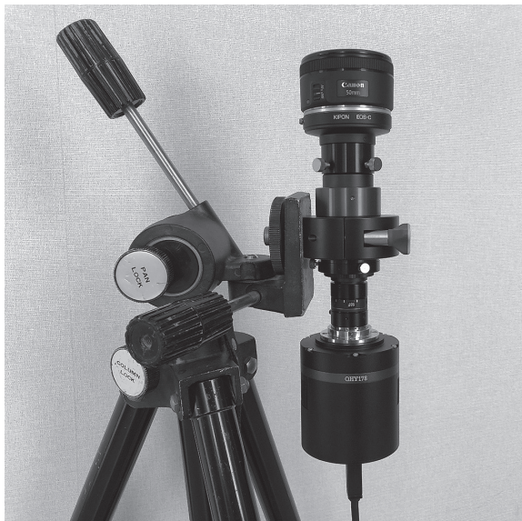
図8. 使用した分光装置を三脚へ固定した様子
