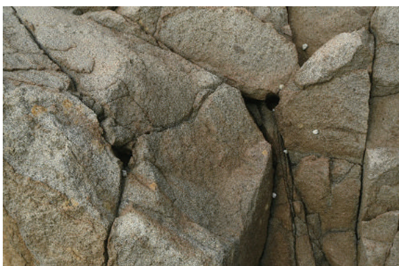
写真26：“七ツ岩”付近の二つのダイナマイト発破孔跡、中心から三方向に割れ目が入っている
